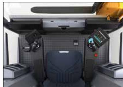
Control de operación dividido (opcional en todas las configuraciones de las series EKK 4 y 5, pero no compatible con paquete de congelador en ningún modelo)
