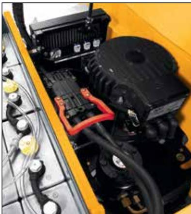
Motor de tracción y de elevación con tecnología AC
