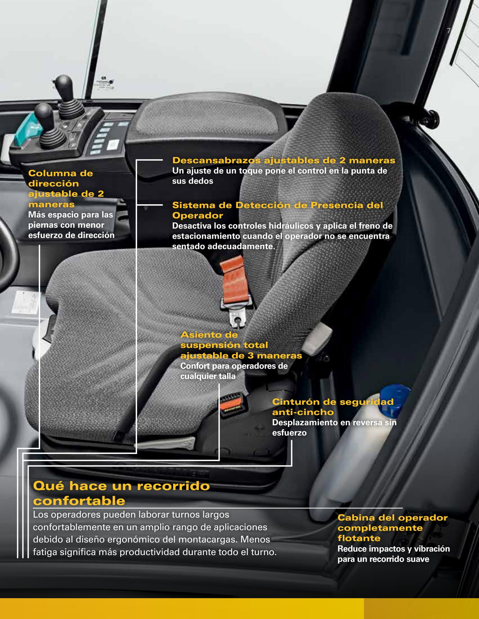
**Columna de dirección ajustable de 2 maneras**
